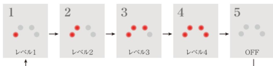
※ウルトラパルスモードの際はレベルランプが点灯し、MFIPモード・EMSモードの際はレベルランプが点滅します。
